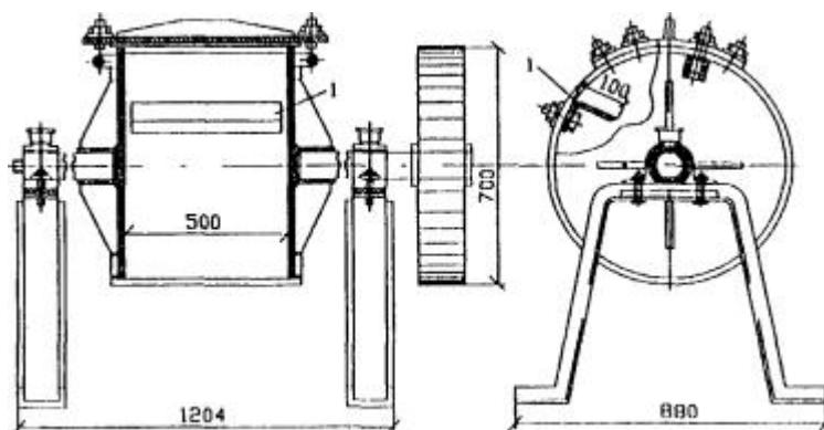
Рис. 1.1.1. Полочный барабан для определения прочности при износе: 1 - полка
